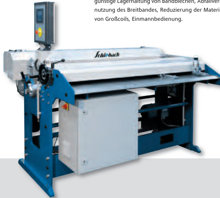
Querteilanlage QTAR 125 mit elektrischer Rollenschiere
