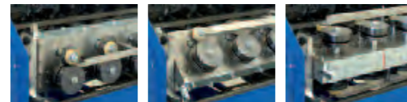
Sehr kurze Umrüstzeiten durch Schwenken oder Austauschen der Wechselkassetten
